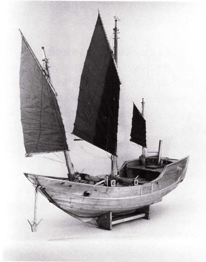
泉州で出土した南宗時期の船の復元模型。船の上に「盤車」があり、木柁は船首の帆柱のすぐ下に設置した「盤車」により操縦される
