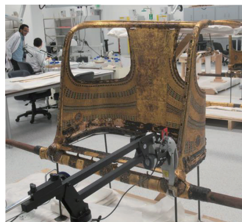
図3. ハンドヘルド型蛍光X線分析装置を用いたエジプト新王国ツタンカーメン副葬品の調査
