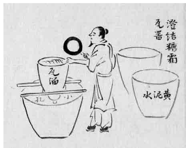
図56 糖漏使用法（天工開物より）
