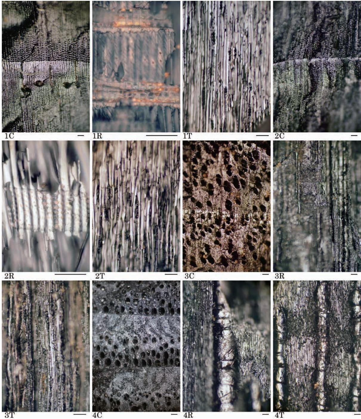
1. マツ属複維管束亜属 (YT-C-165) 2. スギ (YT-C-185) 3. アサダ (YT-C-134) 4. クリ (YT-C-061)
