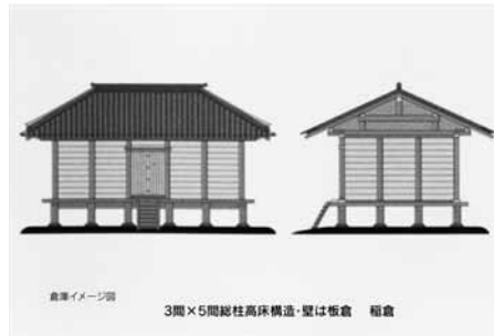
図14 3×5間総柱高床構造
