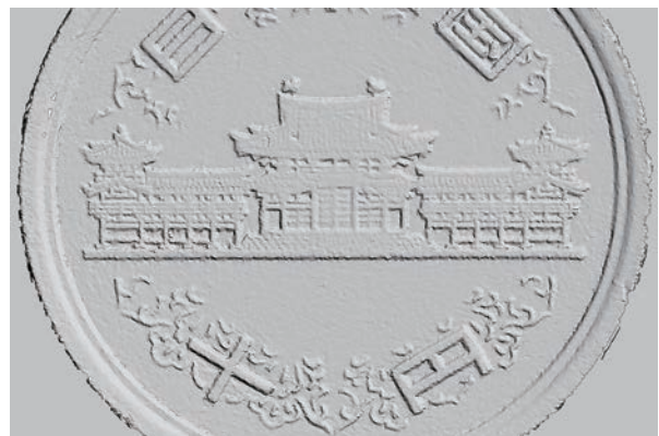
図 164 SfM による 10 円玉表面の形状データ
