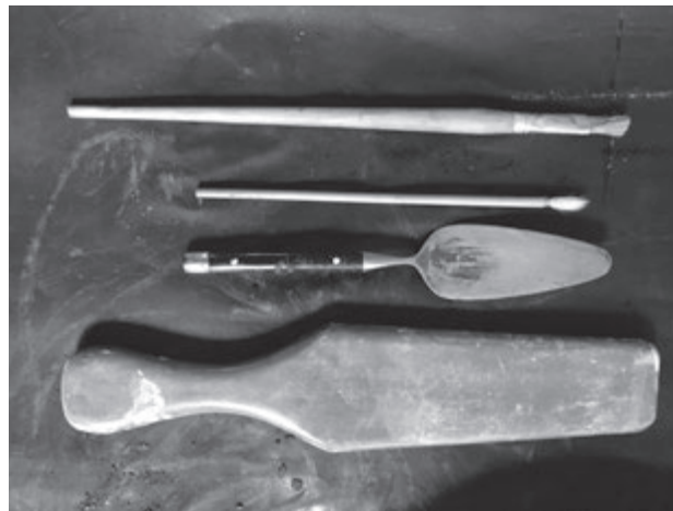
图3 陶范制备时的工具：刮刀、毛笔、条状木锤（筆者提供）
