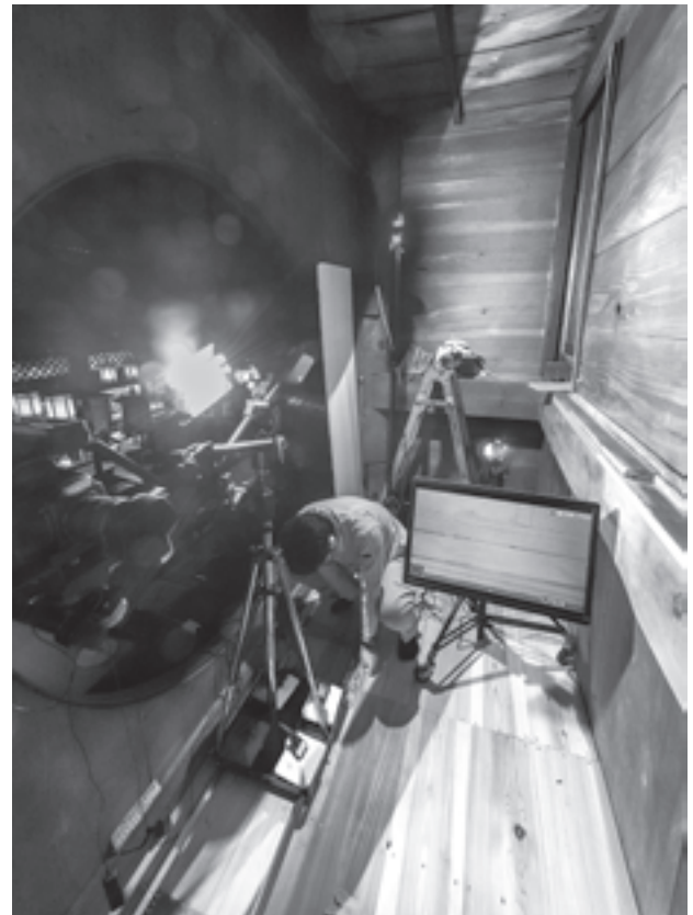
図80 中判デジタルカメラによる赤外線分割撮影風景
