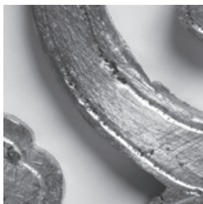
図14 鑄込み後に加工した線彫り
