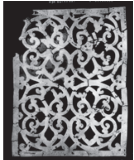
図4 試作品鋳込み後加工実施後の透過X線画像
