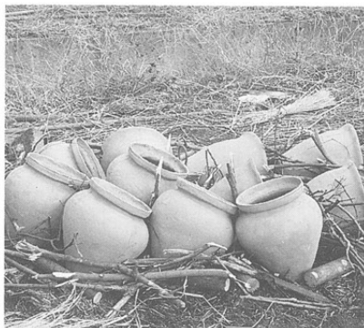
写真16 灰の上に土器を置き、周囲に薪・小枝燃料を置く
