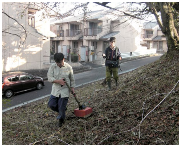
物理探査のようす（地中レーダー探査）
