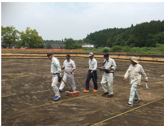
写真2 地中レーダー探査実施状況
