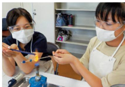
ガスバーナーで溶かしたガラスを鉄芯に巻き付ける技法で小玉やまが玉を作ります。ガラスは単色だけでなく混色したり、別の溶かしたガラスで玉に模様付けしたりすることで、様々なガラス玉を作ることができます。
