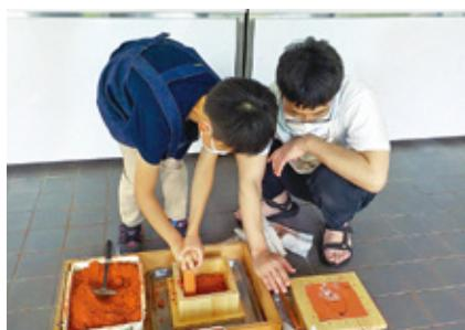
溶かした錫を錫物砂で作った型に流し込み、冷やして固めて作ります。今回つくる鏡の原型は、射水市の上野遺跡から出土した弥生時代の鏡です。この鏡の中心には、花のような内側に向いた6つの扇が連なった文様（内向花文鏡）があります。冷やして固まった鏡の表面を砥石や耐水ペーパーで磨き、仕上げます。
