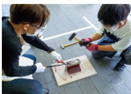
800°C近くまで熱した五寸釘を叩いてペーパーナイフをつくります。「鉄は熱いうちに打て」の言葉どおり、熱しては叩き、熱しては叩きと繰り返し、釘を伸ばして刃を作ります。形づくられた熱い釘は、水に入れて冷やす「焼き入れ」を行うことで強度を高めます。最後に砥石で刃を研ぎ、柄を作つて仕上げます。
