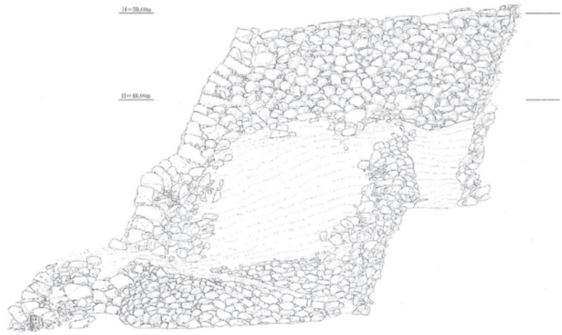
図4 天球丸凸部南面測量図〈S=1/250〉
