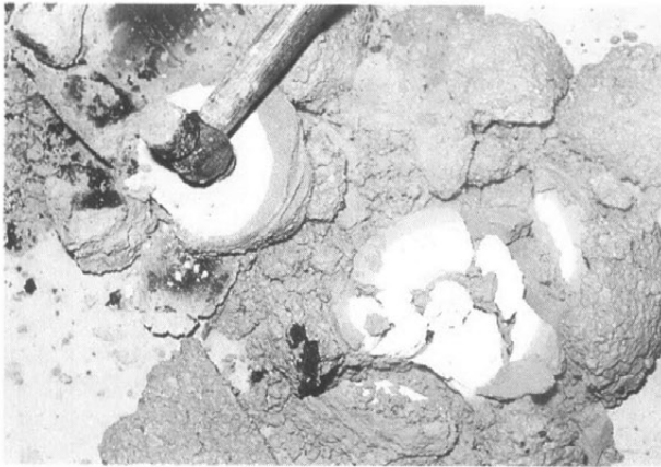
写真7 冷えたら鑄型を壊し、釧を取り出す
