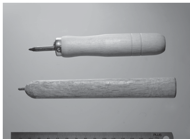
図2 金属製押圧具 (ともにハンドルは木製で、芯が金属製。上：軟質の鉄製、下： 銅製)
