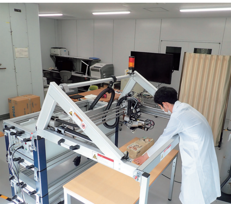
保存修復科学研究室：全資料型非破壊元素マッピング分析システムによる色料の調査
