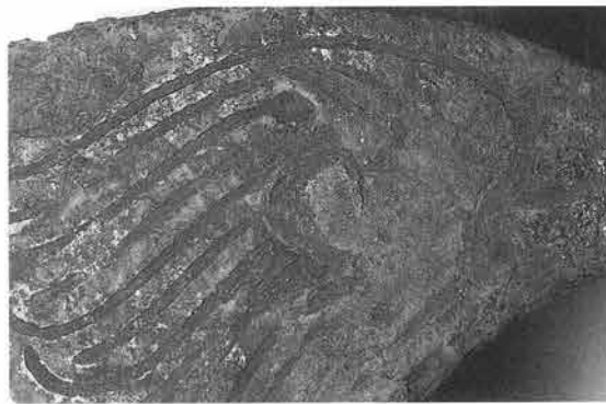
写真8 鏡板・立間接合部の鉄 (左：法住寺殿轡 右：志羅山轡)
