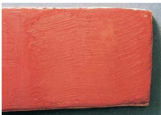
写真4 顔料重ね塗り後ミガキ（部分拡大）
