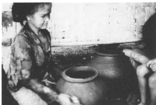
⑦ 筒状の口縁原形はつぶす感じで平らにして行く。さらに内外面を削って器形を整える。
