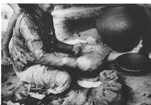
④ 粘土塊を次々に足して指で伸ばし底部原形ができる。成形板は琺瑯皿の上で回る。
