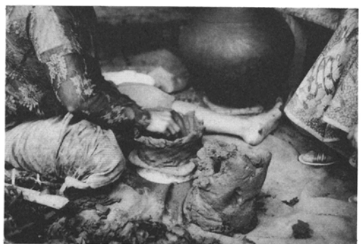
③ 琺瑯の皿の上に成形板を置き、上で粘土塊より成形。（以前は2枚の成形板を重ねる。）
