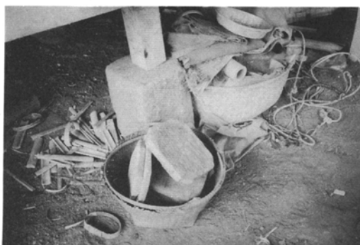
② 中央の籠の中にあるのが成形板。左が竹製の調整具（第11図—2・3）。右は混和済の砂。
