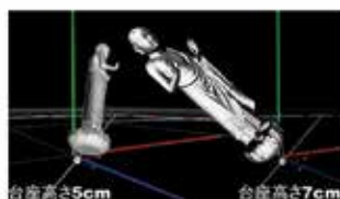
図6: 台座追加に関するシミュレーション → 台座高を定めた場合、転倒方向が異なる
