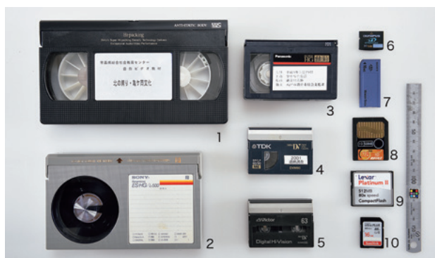
図1 民生用の映像記録媒体 カセット式磁気テープ (1.VHS 2.ベータ 3.VHS-C 4. MiniDV 5.HDV)、メモリーカード類 (6.xD ピクチャーカード 7. メモリースティック 8. スマートメディア 9. コンパクトフラッシュ 10.SDカード) ※2～8は生産が完了しているため、レガシーメディアとも呼ばれる
