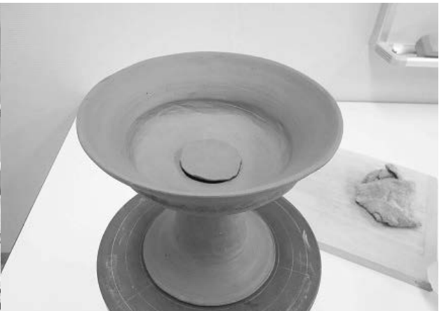
⑥ 杯底部の孔を粘土塊で塞ぐ
