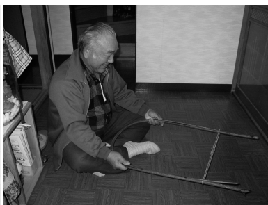
⑪小高箕：手での枠の型づくり
