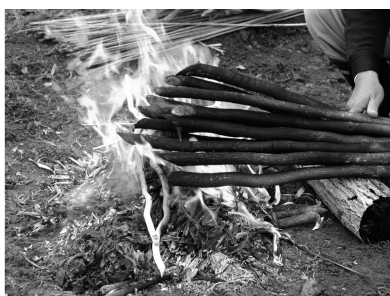
③小高箕：藤皮を剥がすための焼き作業
