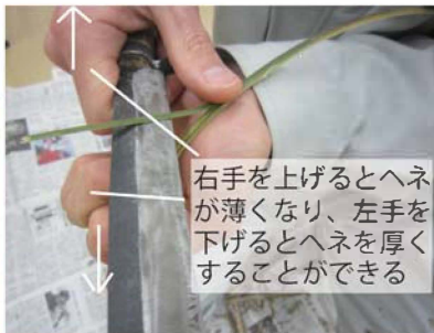
⑥ 「だき剥ぎ」による篠竹のヘネ取り ※指先でヘネの厚さを感じ取る
