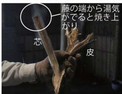
⑫ 藤の皮と芯を分ける ※芯を曲げながら引く抜くと皮が破けない
