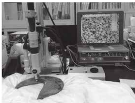
図4：マイクロスコープによる青銅鏡の組織観察
