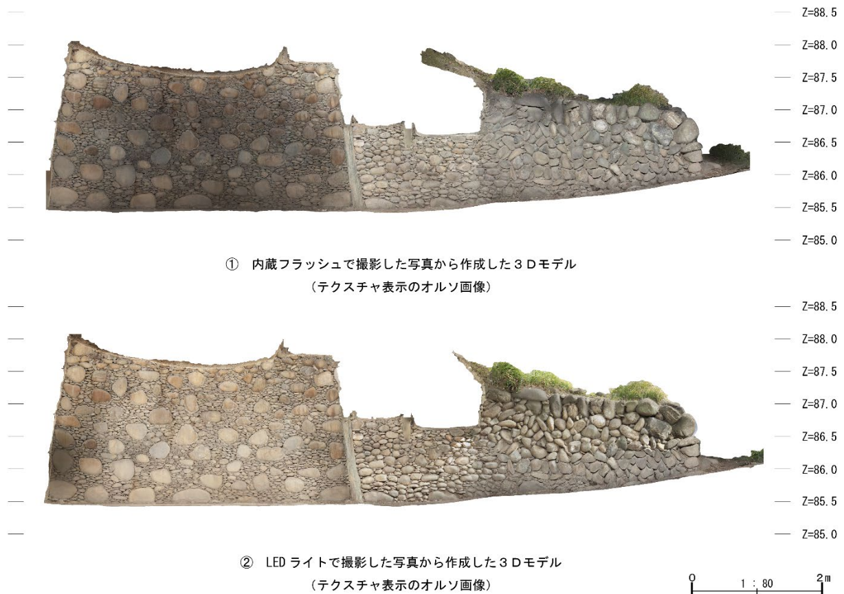
図4 SfM/MVS における内蔵フラッシュと LED ライトの撮影結果の比較 (伊勢塚古墳横穴式石室)
