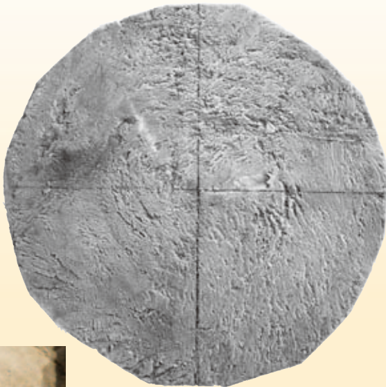
柱根にのこされた加工痕跡(上)と 加工時の墨付(右の赤外線写真)
