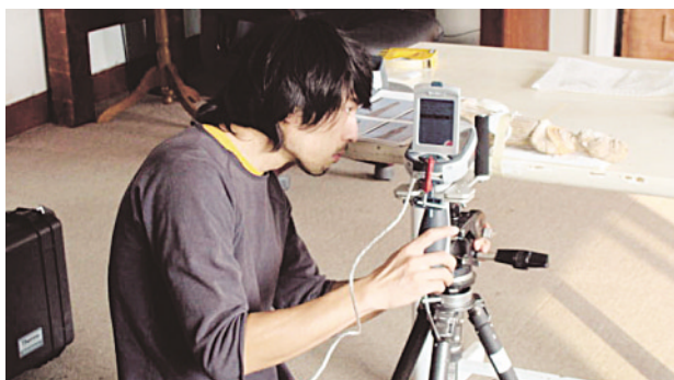
携帯式蛍光X線分析装置での調査
