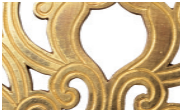
図59 鍍金層が薄く地金の赤色が透けて見える金具 (No.36)
