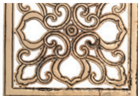
図61 電気メッキ後変色した金具 (No.A)
