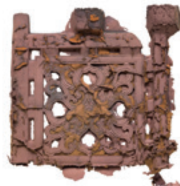
図51 亀裂修理後の鑄型から取り出した状態 (No.23)
