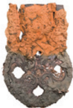
図52 鑄型内に十分に銅湯が回らなかった状態 (No.8)
