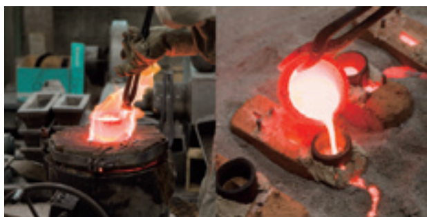
図54 銅湯を小型の坩堝に移し鑄型にそそぐ
