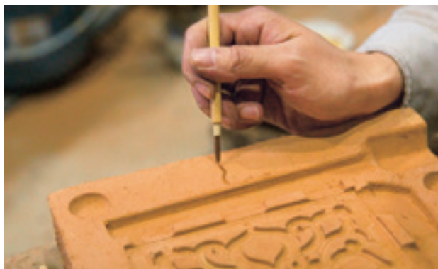
図50 鑄型の亀裂修理
