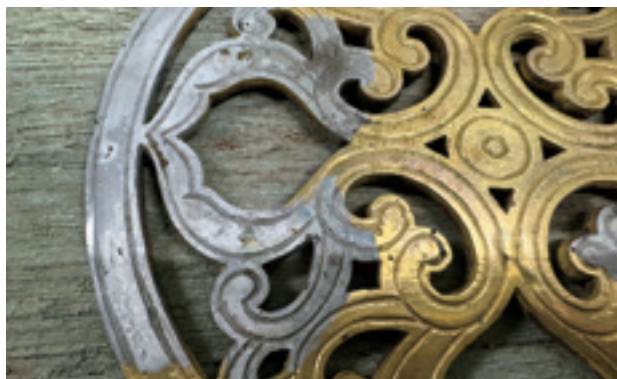
図58 鍍金完了後水銀が湧出した純銅製金具 (No.2)
