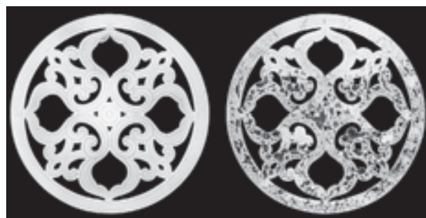
図55 鑄造後のX線透過撮影 (左：青銅No.33、右：純銅No.B)
