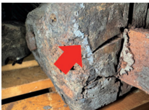
図5 木製品から析出した硫黄化合物
