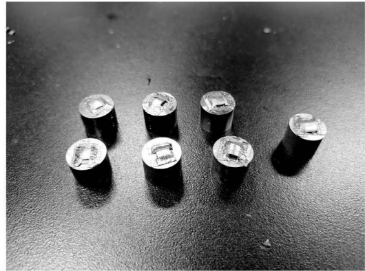
写真2 プラチナコーティングした試料
