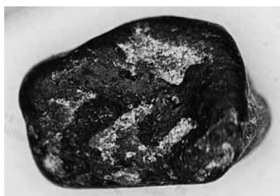
図22 第6層。微砂が詰まる長円形～条痕状破碎孔に微砂が詰まっている。礫は緻密玄武岩。粒径は4mm。
