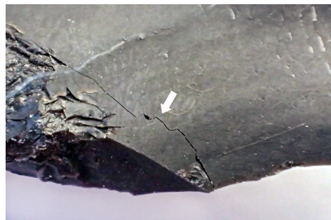
8. 直線状亀裂(矢印)(写真幅約1.5cm)
