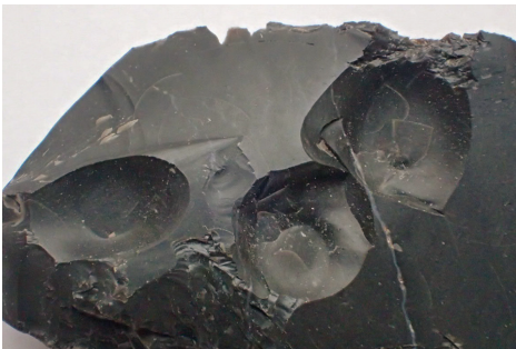
5. ポットリッド状剥落痕跡(写真幅約2.8cm)
