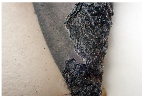
6. 5右の拡大: 剥離面の状態(写真幅約1.9cm)
