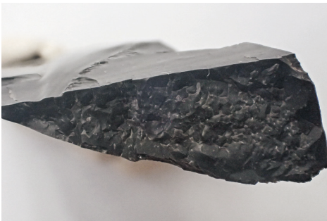
3. 微細な凹凸のある破断面(写真幅約2.3cm)
