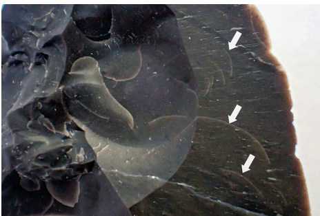
7. 円弧状亀裂(矢印)(写真幅約1.7cm)
