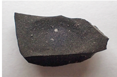
2. 内部から発する破断面(写真幅約2.1cm)
