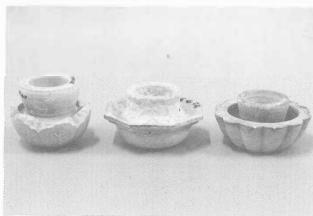
写真23・24 「八輪花形鉢」成形用土型 (No.845) 径15.5cm 銘「△」
