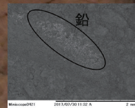
「失鉛法」鑄型SEM像
