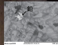
「失鉛法」試料表面SEM像
