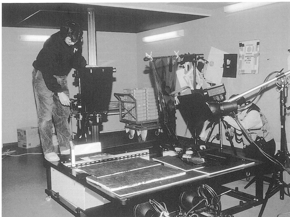
ストロボ撮影だが、赤い光の成分を照射するため光源前にフィルターを垂らす
