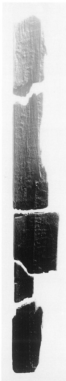
写真2 ライトを低くしてセッティングすると墨痕は表現できるが均一にライティングできない(図3の状態)
