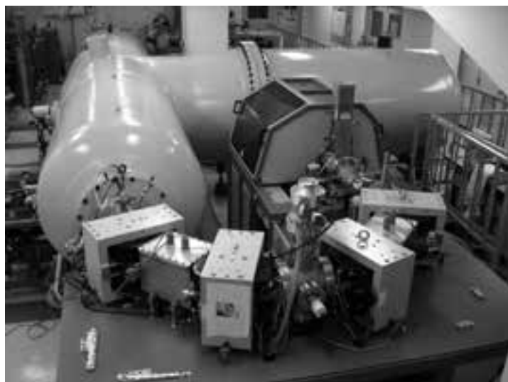
写真 2 名古屋大学年代測定総合研究センター AMS システム
