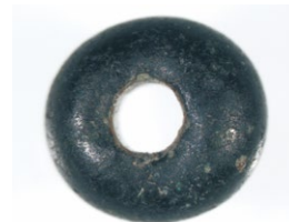
写真 11 鋳型法によるガラス小玉 ( \text{Fe}_2\text{O}_3 および CuO を多量に含む黒色) No.4-060
