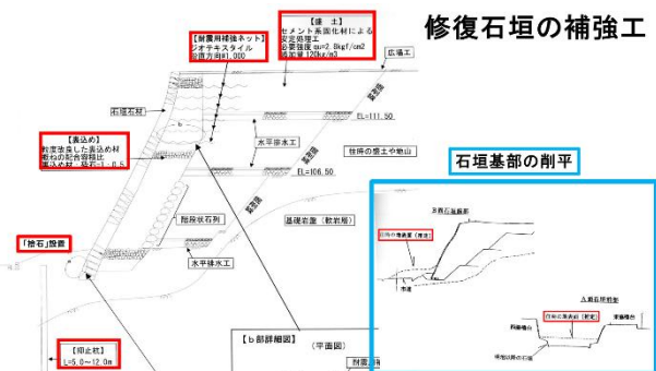
第21図 修復石垣に採用した補強工
