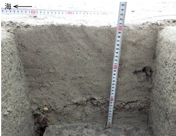
①U字溝断面 内幅30 cm×深さ30 cm. 片（海）側に幅約3 cmの狭い溝が切っている。この狭い溝には、腐植物の根が残され、陸側になぎ倒されている。
