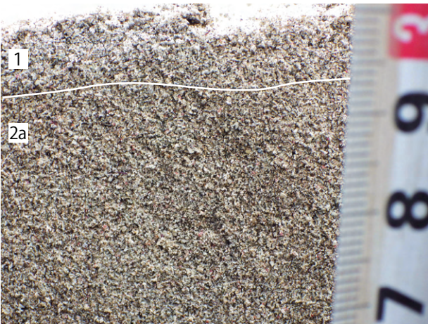
⑤sampleA 全体を覆う表層の1層は白色度が高い極細粒砂の下に、細～中粒砂の2a層が堆積している。2a層には2 mmほどのごく細かいラミナがあり、2b層に漸移する。
