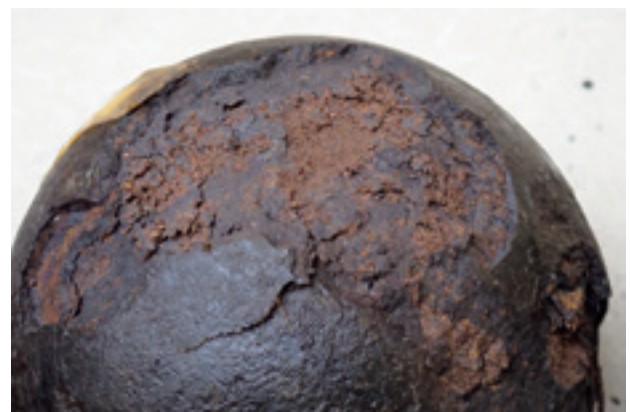
図4 展示中に劣化が進行した鉄製遺物
