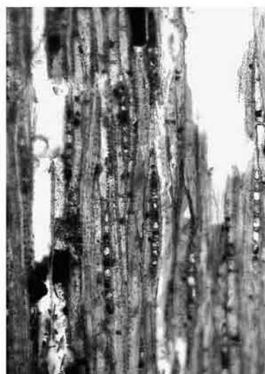
横断面 ————— : 0.5mm 放射断面 ————— : 0.2mm 接線断面 ————— : 0.2mm 4. No. 16 (2区SB8 - ②) 木柱 クリ
