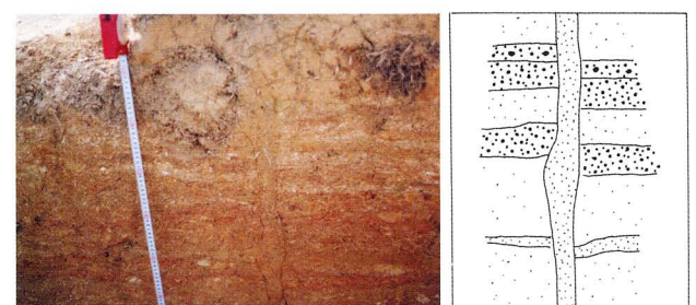
Fig. 48 トレンチ南壁における亀裂とその断面図
