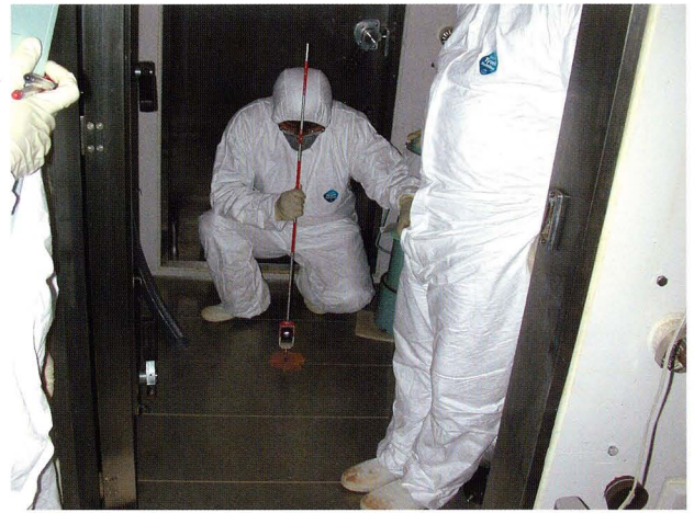
Fig.57 保存施設内の基準点移動作業
