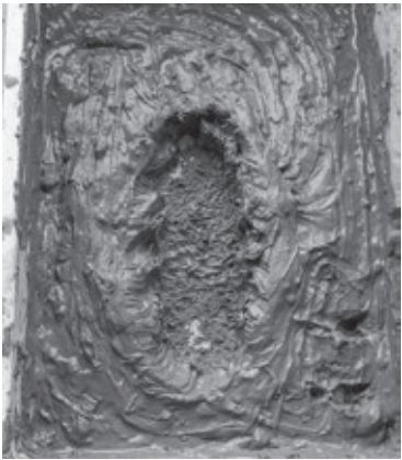
写真28 含水比32.51%のS1で作成した草鞋(中央)と下駄(右下)の足跡
