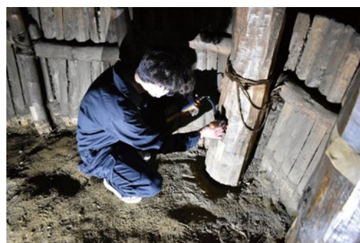
2. 表面含水率 電気抵抗法
