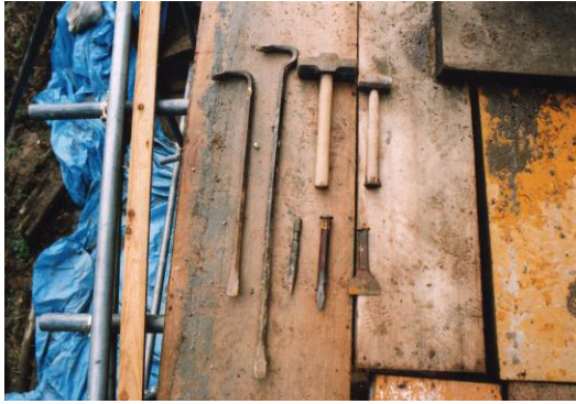
第 22 図 百間石垣修理・復元で用いた加工具
