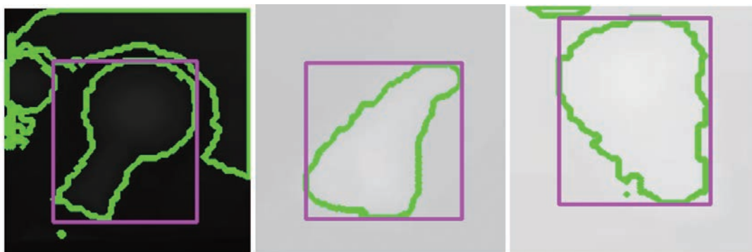
(図6) OpenCV による DEM 全域画像内での前方後円墳抽出結果
