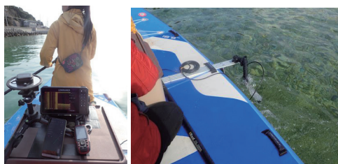
図5 スキャンソナー機材とRTK-GNSS
