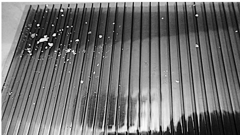
図2 ポリカーボネート板上の微小剥落片
